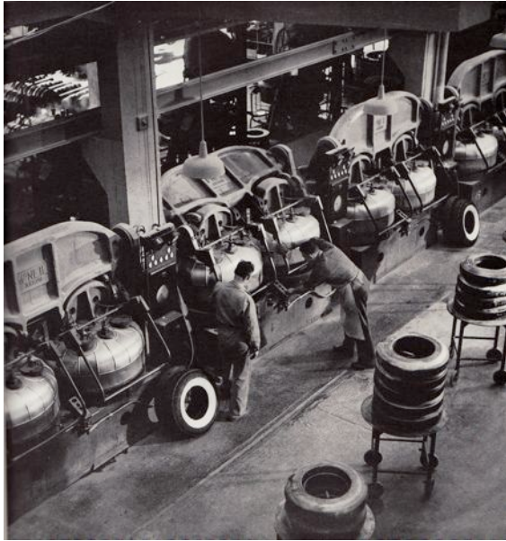
Fig. 8- Pfäffikon, fabbrica Huber: presse per la vulcanizzazione delle ruote di gomma (libro di Ida Capraro)
